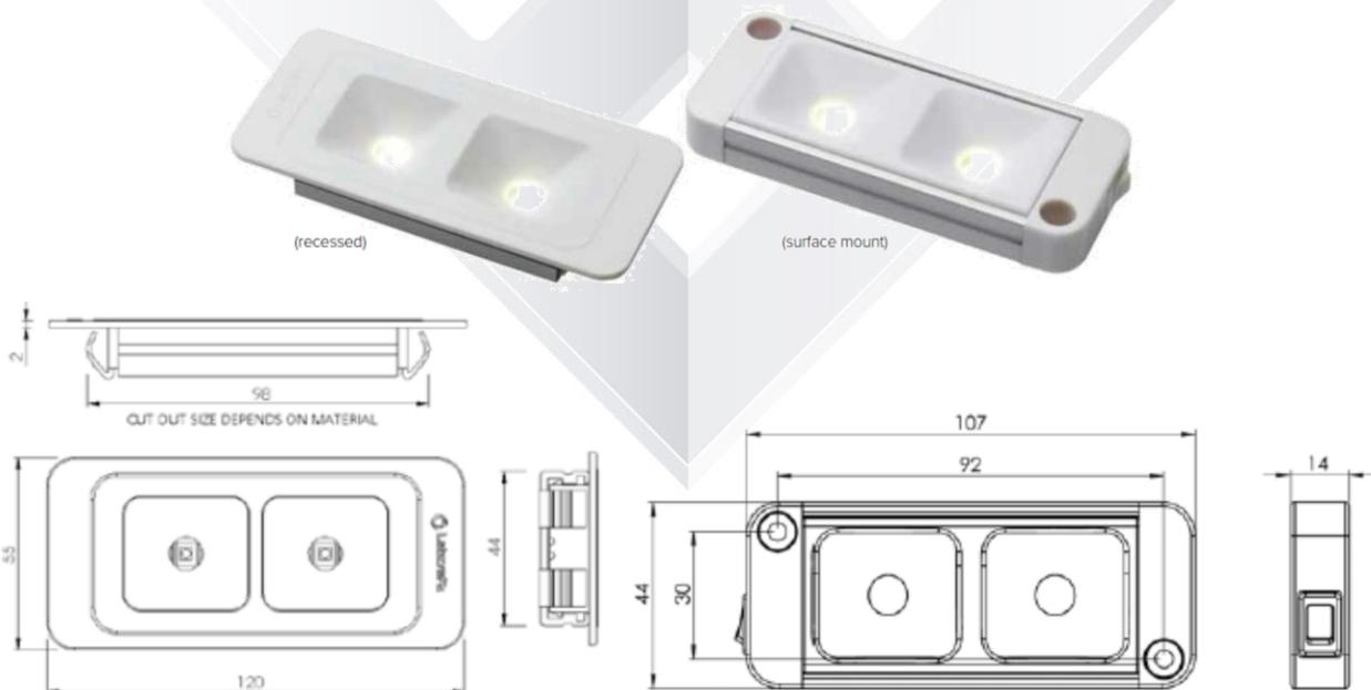
**CONFIGURACIONES****12 VDC****TI3\_2-1MVS***Rango de voltaje: 10-32 VDC**Corriente : 0,22A**Luminosidad: 354 lm**Potencia: 2,7 W**Peso: 0,062kg**Rango de temperatura: -30 a +40 °C
